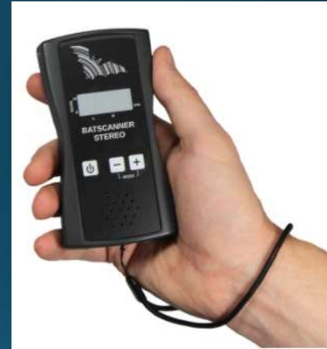
Der BATSCANNER STEREO ist ein einfach zu benutzender Fledermaus-Detektor. Er wandelt die Ultraschall-Fledermausrufe in den hörbaren Frequenzbereich nach dem Überlagerungsprinzip (Heterodyn). Was den
